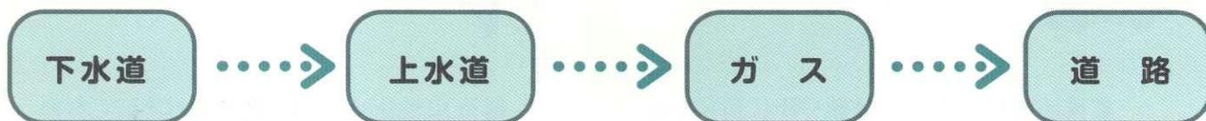
● 『施工を同時に出来ないの?』という声を聞きますが、同時に施工する場合、図のAの部分も余計に掘ることになり、工事費が増えてしまうため、フローのような流れで施工を行っております。
